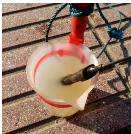
Figura 49: Toma de mostras e medición de condutividade
